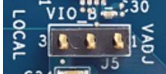
Figure 4: J5 VIO_B Header
